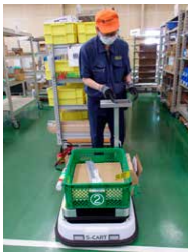
材料はバーコードが付与された棚で管理。現場から出荷要請があると無人搬送台車で指定の場所へ運ぶ
