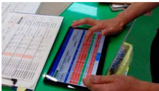
受注部品がどの工程にあるのかはタブレットで確認できる。完了した工程、現在の工程など色分けされていて識別できる
